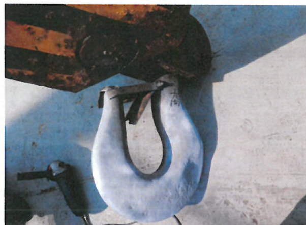
吊车大钩（试重后）
