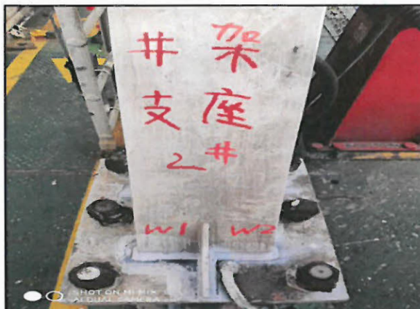
井架支座 2 号 W1 W2 (应力测试前)
