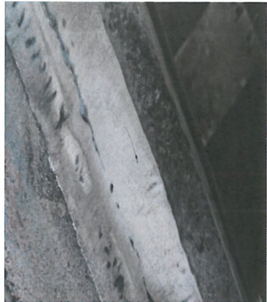
母材边缘 15mm 处裂纹长度 12mm
