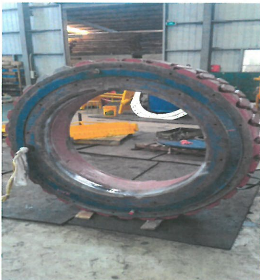
打磨补焊后复检合格
