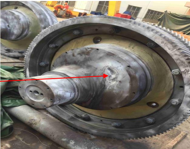
2 号泥浆泵主轴轴承齿轮
