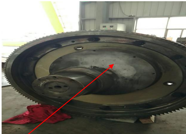
1 号泥浆泵主轴轴承齿轮/非接触面
