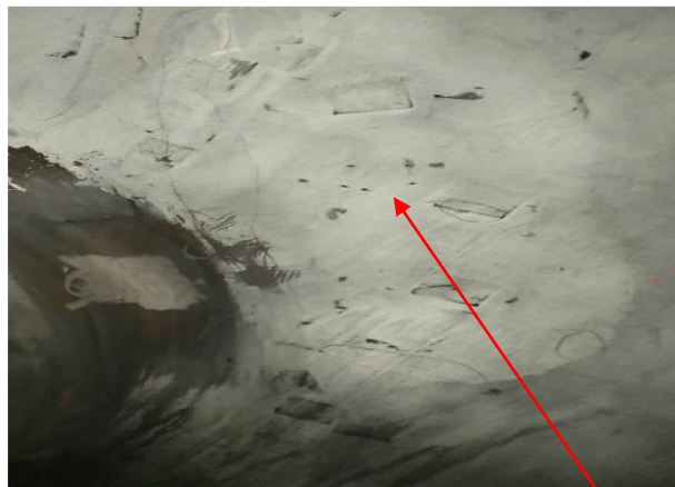
1 号泥浆泵主轴轴承齿轮/非接触面返修后(缺陷部分)
